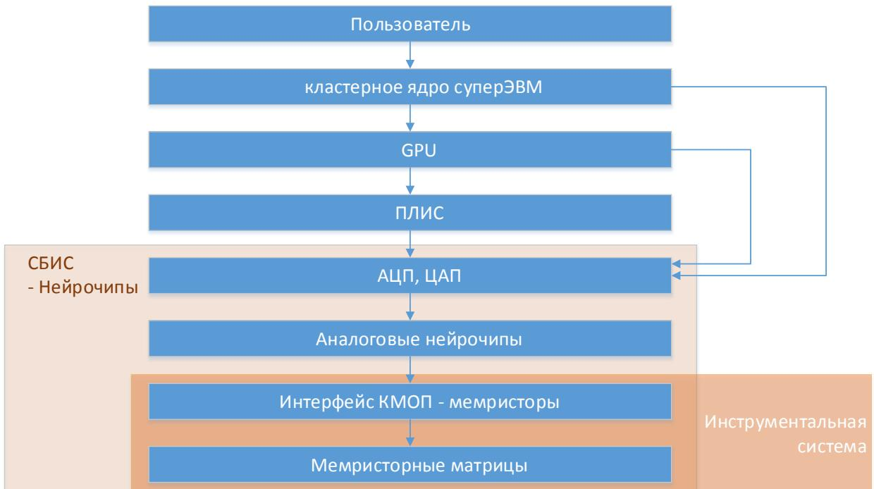
Рис.30а. Функциональная структура перспективных супернейрокомпьютеров с применением мемристоров как основа для разработки методов распараллеливания нейросетевых алгоритмов
