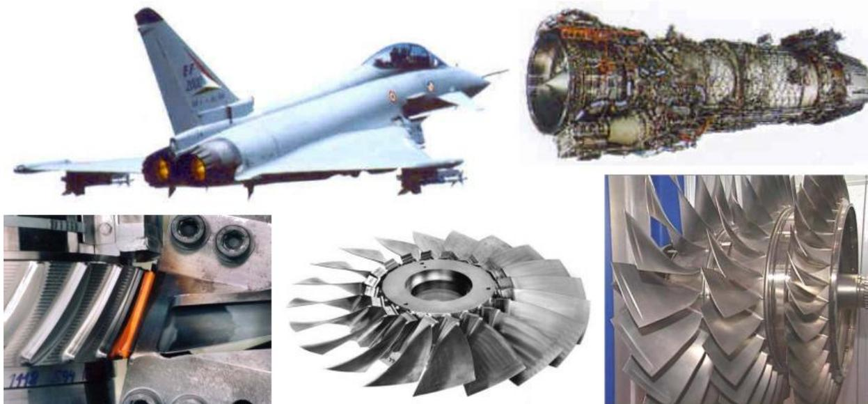
**Рис.1.** Истребитель EuroFighter Typhoon, его двигатель, а также процесс создания блиска, блиск после сварки до механообработки и компрессор низкого давления в сборе с блисками, полученными при помощи технологии ЛСТ.
